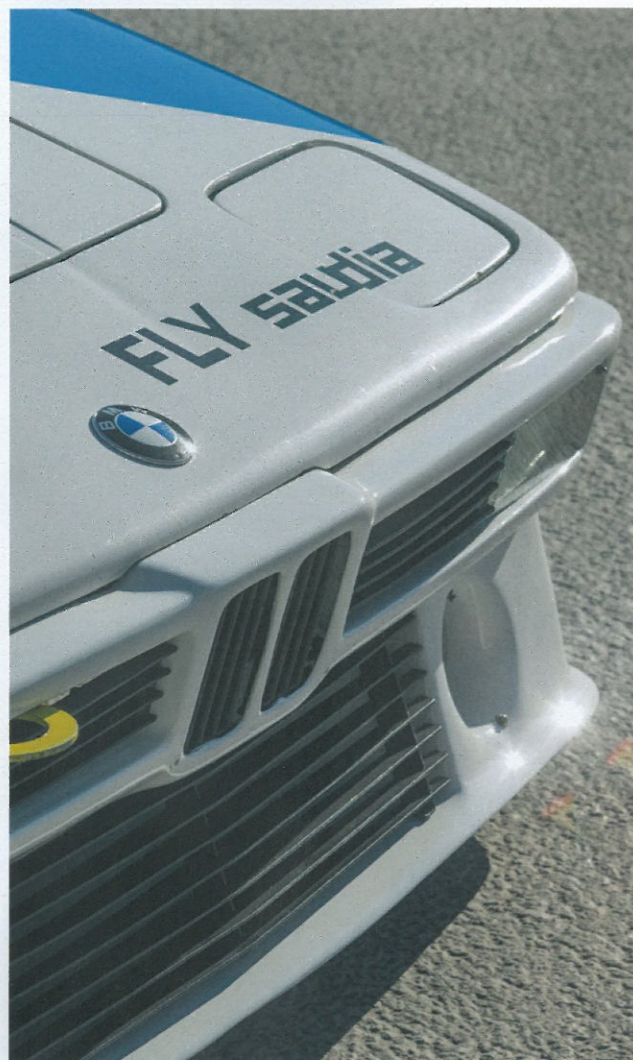
Für die Rennstrecke optimiert: Tiefer Frontspoiler, Verbreiterungen, grosse Räder an Zentralnaben.
